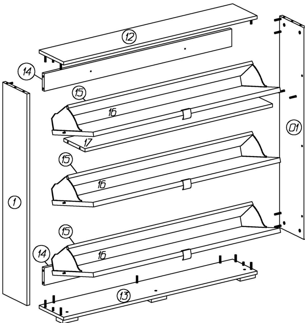
На деталях **12, 13** в установленные муфты вернуть дюбели, в отверстия без муфт вставить шканты.
