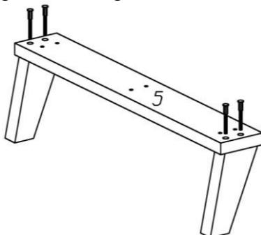
Планки **5** с установленными на них ножками при помощи винтов M6x30 закрепить ко дну стола **4**. Для чего винты через отверстия в планках ввернуть в муфты, установленные на детали **4**.
