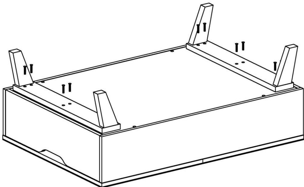
Установить стол на ножки, проверить корректную работу механизма раздвижения.
