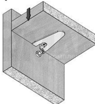
На планках 5 конфирматами 7x50 закрепить по две ножки. Для крепления ножек используются крайние пары отверстий. Отверстия смешены к наружной кромке.
