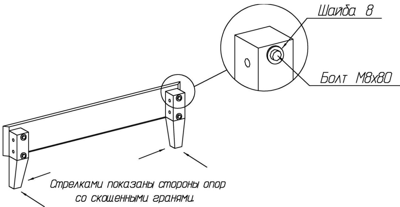
3. Ввернуть дюбели эксцентриков в муфты, установленные в продольных царгах кровати. Вставить эксцентрики в отверстия на планках средних основания, таким образом, чтобы стрелка была повернута в сторону отверстия в торце. Собрать между собой продольные царги и средние планки с помощью эксцентриковых стяжек. Затянуть эксцентрики, повернув их на 180 градусов.
